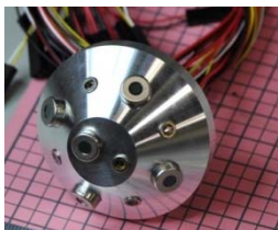
マグネシウム削りだし 超軽量主翼桁構造
